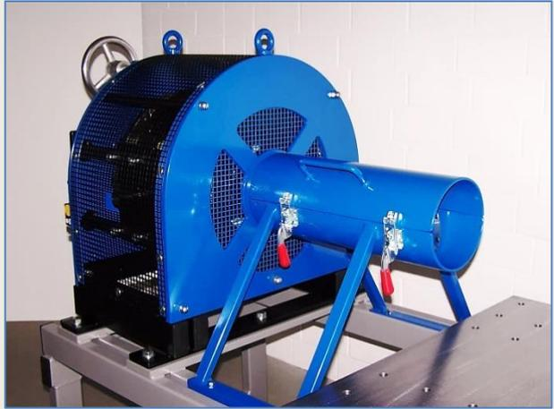
Gelenkwellenschutzvorrichtung mit Gelenkwellenkupplung am Leistungsprüfstand LPS 1600 LK
