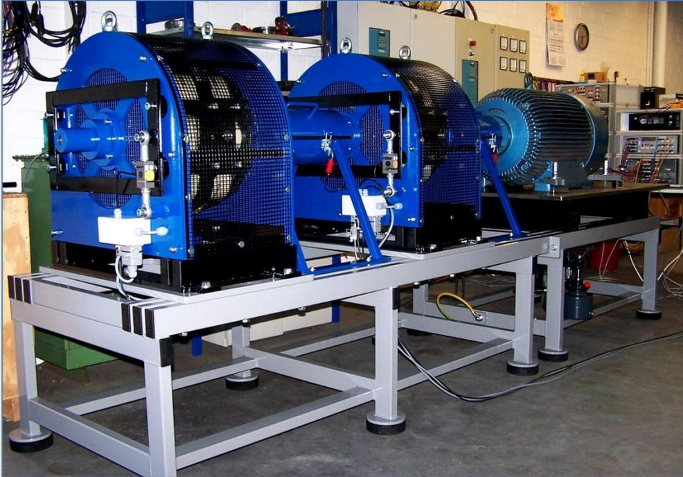
WEKA-POWER Leistungsprüfstand LPS 5000 LK zur Endkontrolle im Prüffeld des Herstellers
